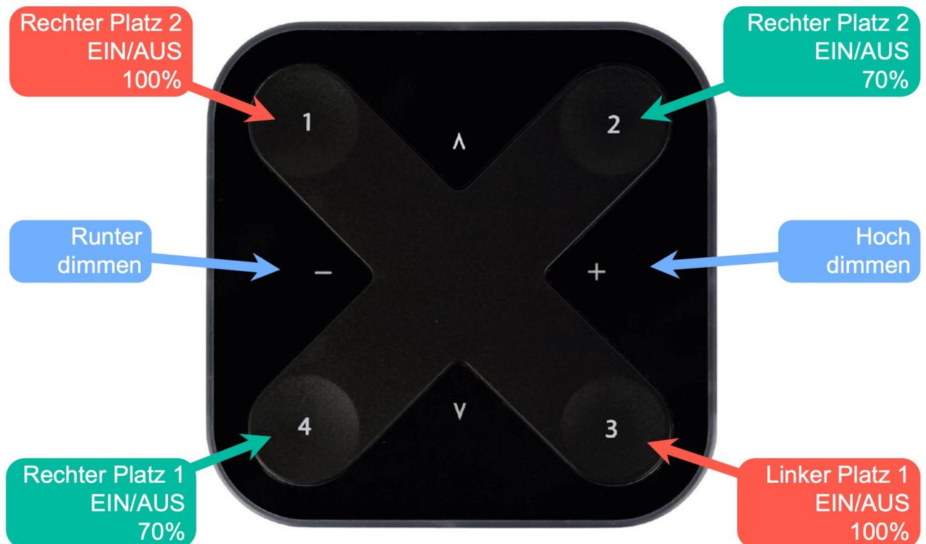
Bei Verwendung der Dimmer Tasten (blau) ist darauf zu achten, dass der Dimmzustand bei der benutzen „Preset Taste“ (rot/grün) gemerkt wird und der Dimmzustand von Hand auch wieder geändert werden muss. Der Einfachheit also bitte nur die „Preset Tasten 100%“ (rot) für Platz 1 & 2 verwenden.
